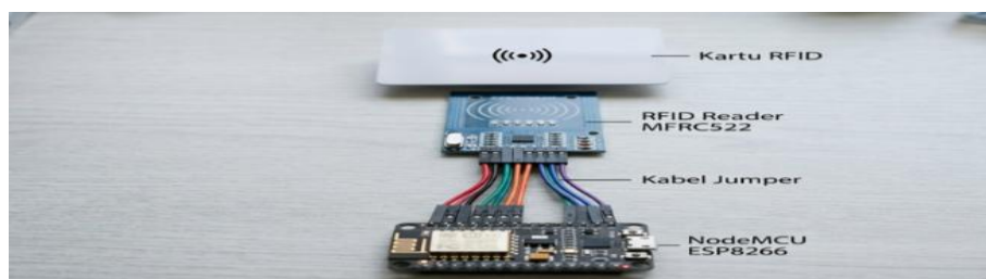
Gambar 6 Implementasi Perangkat Absensi RFID
